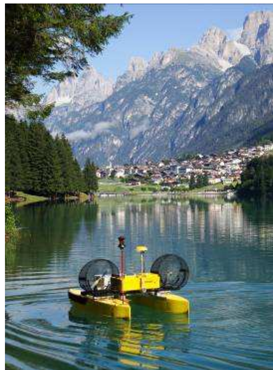
Fig. 2,3 – La famiglia di natanti robotizzati CatOne (Unmanned Surface Vessels, USV) senza timone e propulsi da ventole aeree
