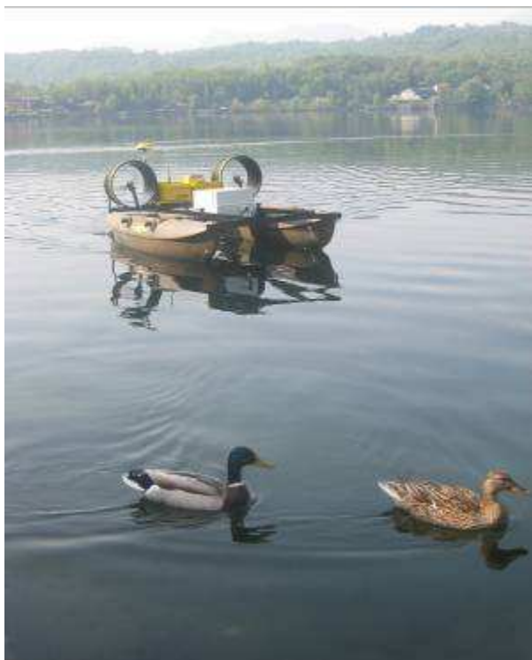
Fig. 2,3 – La famiglia di natanti robotizzati CatOne (Unmanned Surface Vessels, USV) senza timone e propulsi da ventole aeree
